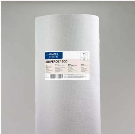
KEMPEROL® 500 Vlies besteht aus einem hochvernadelten Polyesterfaservlies mit einem Quadratmetergewicht von 50 g. Die Standardrollenbreiten betragen 70 cm ( Länge 50 m ) und 15 cm ( Länge 25 m). KEMPEROL® 500 Vlies wird in die Abdichtungsvorlage mit einer Überlappungsbreite von mind. 5 cm
