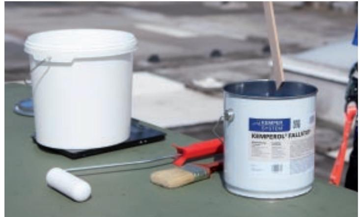
Für die Verarbeitung von KEMPEROL® FALLSTOP werden eine digitale Waage, Abklebeband, die KEMPERTEC® Schaumstoffrollen, Pinsel, Rührhölzer und der KEMPERTEC® V4A Messkamm benötigt.
