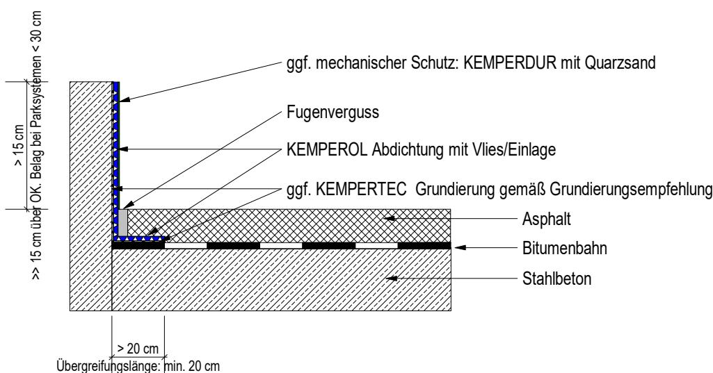
Die Zeichnung ist eine schematische Darstellung für die Herstellung einer FLK Abdichtung mit KEMPEROL unter Asphalt und mit Anschluß auf einer Bitumenbahnabdichtung.
